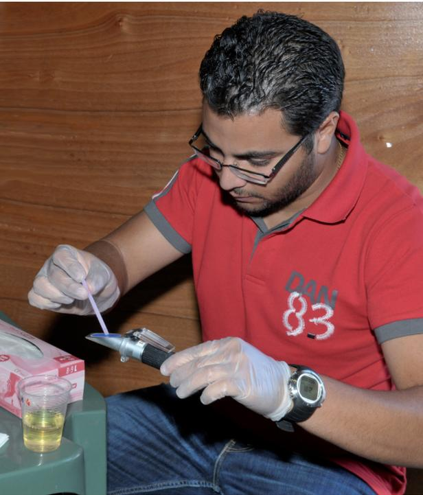
Ein DAN Europe Forscher führt die Messung der Dichte des Urins während eines DAN Forschungsevent durch. Dieser Test bestimmt das spezifische Gewicht des Urins, welches vom Hydratationszustand des Tauchers abhängt.
